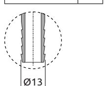
**Drehschlauchanschluss aus Nylon®****Нейлоновое поворотное соединение со штуцером****Złączka obrotowa z Nylonu® ze złączką do węza**
